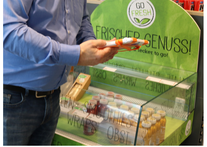
Soğutma ünitelerindeki çevrimiçi veri kayıt cihazlarından ölçüm değerleri Kontrol Ünitesi kullanılarak okunabilir ve alarmlar işlenebilir.
