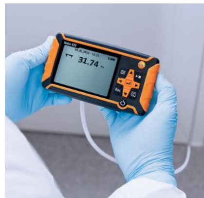
Misura della pressione differenziale con tubo flessibile di collegamento
