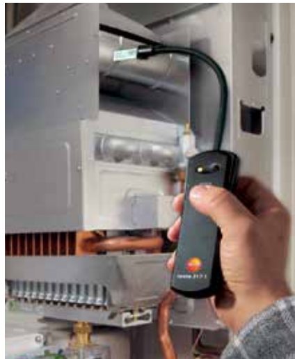
Abb. 17: Anwendung des Rückstauemlders testo 317-1
