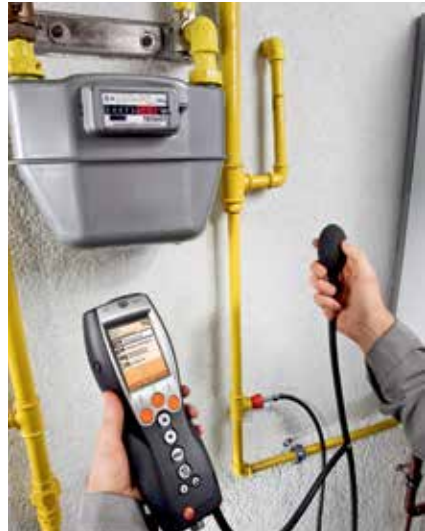
Abb. 19: Mit einem Rauchgasanalysegerät lassen sich einfach und präzise alle wichtigen Mess- und Berechnungswerte ermitteln.
