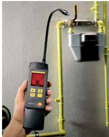
Abb. 20: Lecksuche an Gasleitungen mit dem testo 316-2
