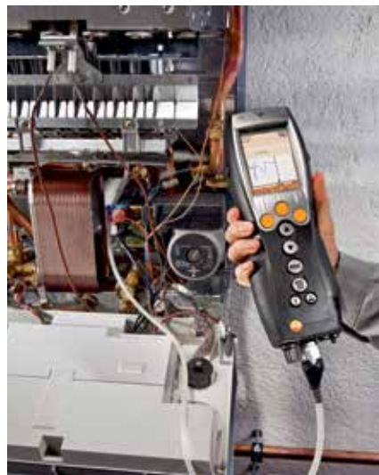
Abb. 15: Mit dem Abgas-Analysegerät testo 330 können neben den Abgas-Messwerten auch schnell und präzise Absolut- und Differenzdrücke gemessen werden.
