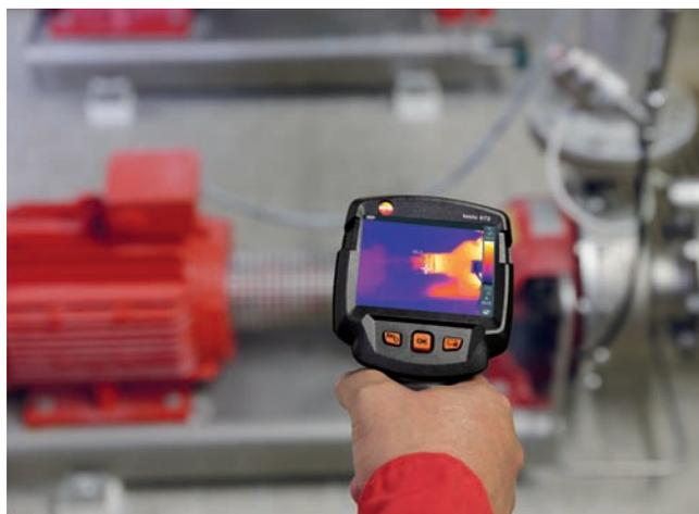
Тепловизор можно использовать для обследования электрических и механических агрегатов системы КЭС\* во время их работы и с безопасного расстояния — сокращая тем самым время простоя установки, увеличивая срок её службы и повышая эффективность использования энергии. В сравнении с потерями от операционных простоев, сервисное обслуживание установок с помощью тепловизора исключительно выгодно.
