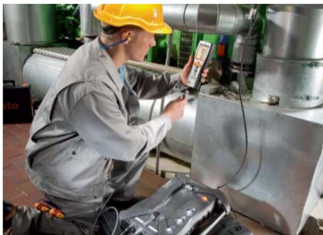
Анализатор дымовых газов testo 350 — удобный в использовании прибор для измерений выбросов на когенерационных\* установках. Анализатор отличается интуитивным управлением и имеет специальные измерительные меню, которые можно адаптировать под разные задачи (например, двигатели с коэффициентом избытка воздуха  $\lambda \leq 1$  или  $\lambda > 1$ ). В сочетании с блоком пробоподготовки Пельтье, testo 350 обеспечивает быстрые и высокоточные измерения.
