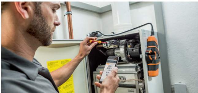
Die Messwerte werden vom testo 330i kabellos per Bluetooth an die testo 330i App übertragen.
