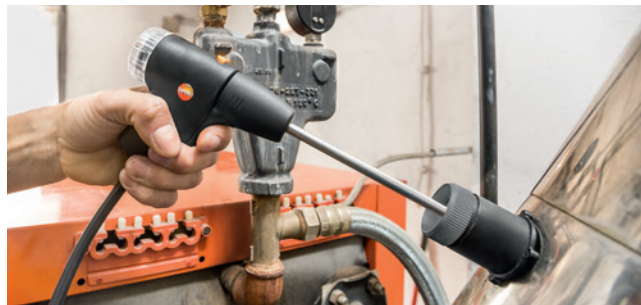
Dank der testoFix-Sondenhalterung sitzt die Abgassonde immer fest im Kernstrom.
