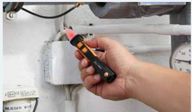
Misura senza contatto della tensione su una scatola di distribuzione di un impianto di riscaldamento con lo strumento testo 745.
