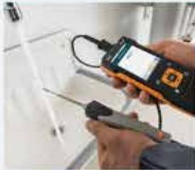
**Sonda a immersione/penetrazione impermeabile (NTC)**
