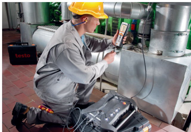
Préparation d'une mesure de contrôle sur une centrale de cogénération au moyen d'un testo 350.
