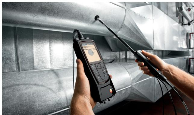
Strömungssonden mit Skalierung erleichtern die Bestimmung der Eintauchtiefe im Kanal.
