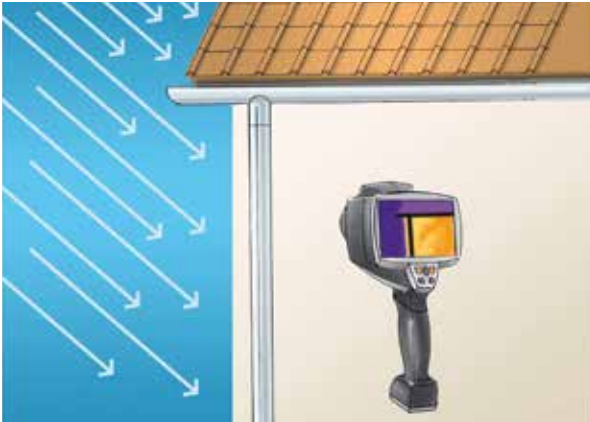
Abbildung 2.1: Reflexion bei Messungen im Freien
