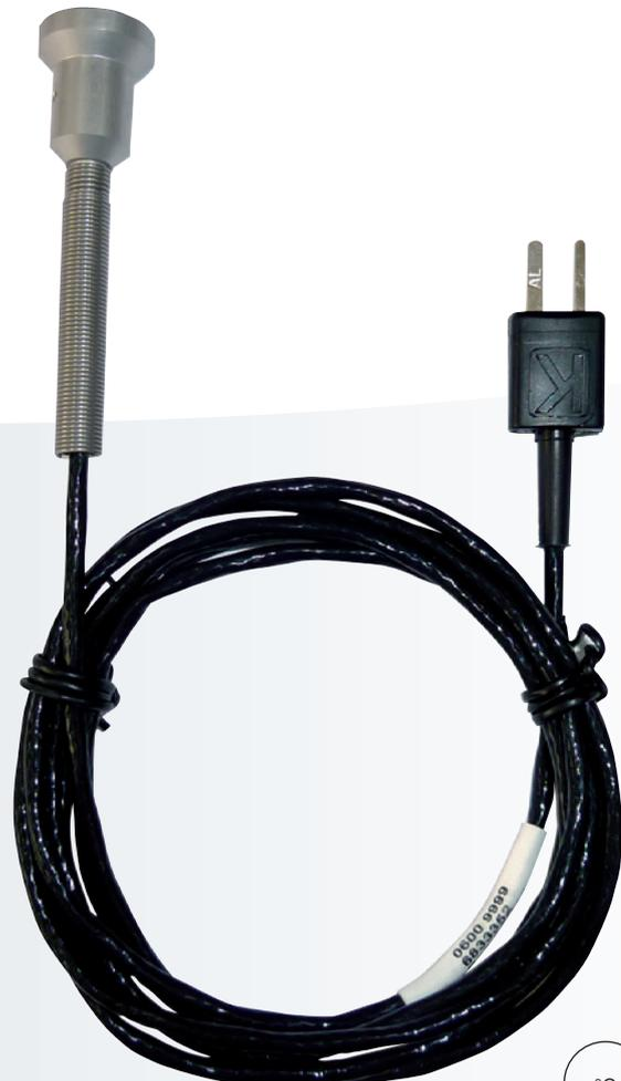
Der kalibrierfähige Magnetfühler ist speziell für Temperaturmessungen an magnetischen Oberflächen geeignet. Hauptanwendungsbereich sind Messungen im Rahmen der Prozessüberwachung, bei denen mit hoher Verschmutzung z. B. durch Metallspäne, Staub oder Produktionsreste zu rechnen ist. Die magnetische Messfläche mit einem Durchmesser von 10 mm lässt sich bequem mit Druckluft reinigen.
