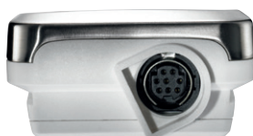
Conector în partea inferioară a carcasei pentru atașarea sondei externe NTC (doar testo 175 T2)
