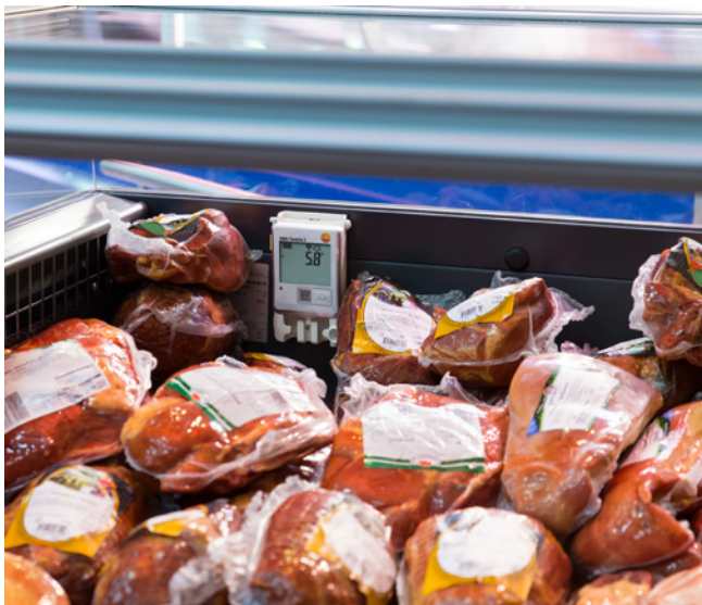
Draadloze dataloggers maken het moeizaam met de hand documenteren van afzonderlijke vitrines overbodig.
