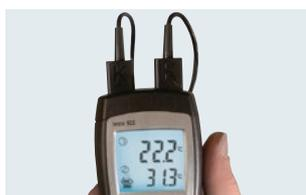
温度差表示 (温度プローブ2本接続時)
