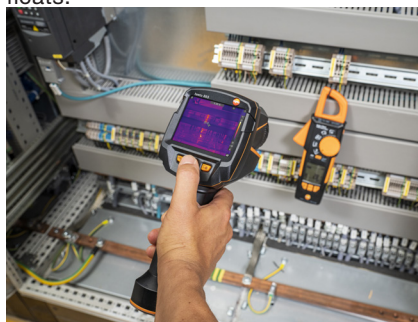
Thermographie d'une installation électrique avec mesure des courants de service au moyen d'une pince ampèremétrique.
