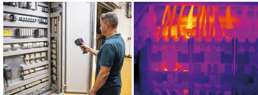
Une caméra thermique est utilisée pour inspecter les fusibles et connexions dans les armoires électriques.
