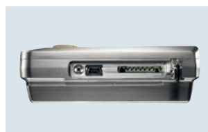
Seitlicher Anschluss von Mini-USB-Kabel und SD-Karte
