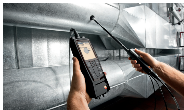
Le sonde di velocità d'aria con scala semplificano la determinazione della profondità d'immersione nel condotto.
