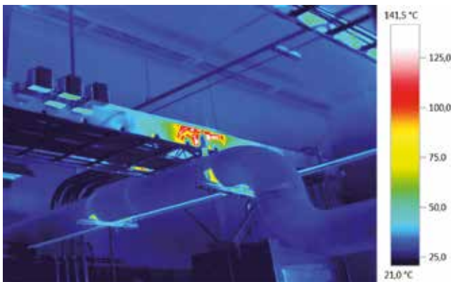
Das heißgelaufene Lager einer Transportstraße ist deutlich zu erkennen.
