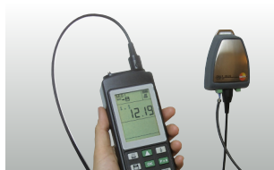
Kontrola převodníků pomocí rozhraní 4...20 mA
