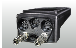
2 libovolně osaditelné vstupy sond pro tlak a teplotu
