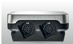
Konektory sond na spodní straně pouzdra pro dvě teplotní / vlhkostní sondy
