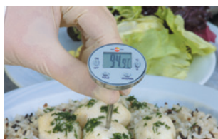
Für Temperaturstichproben-Messungen in der Lebensmittelproduktion.
