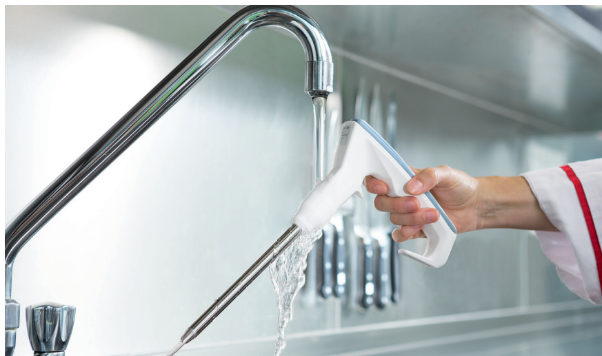
Figura 28: Capacul de protecția detașabil (TopSafe) și cureaua de mână ale testo 270 oferă protecția optimă pentru instrumentul de măsură
