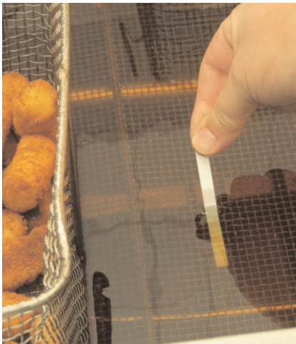
Figura 22: Măsurarea acizilor grași liberi folosind un bețișor de test
