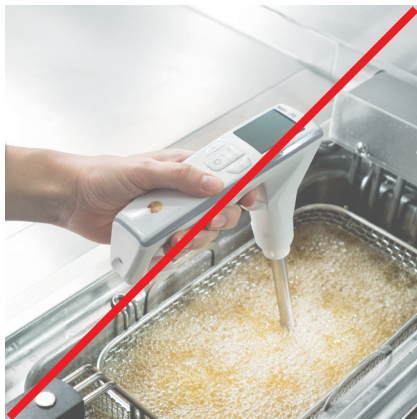
Figura 30: Greșit – măsurătoare în timpul prăjirii produsului
