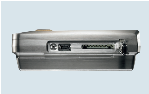
Mini USB kablosu ve SD kart yan bağlantısı
