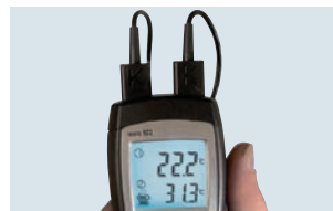
Gleichzeitige Temperaturerfassung von zwei angeschlossenen Fühlern und Differenz-Temperaturanzeige
