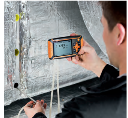
Pitot buis meting (drukverschil)
