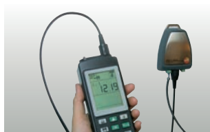
Überprüfung von Messwert-Umformern mit 4...20 mA-Interface
