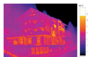
Wärmebild mit testo ScaleAssist
