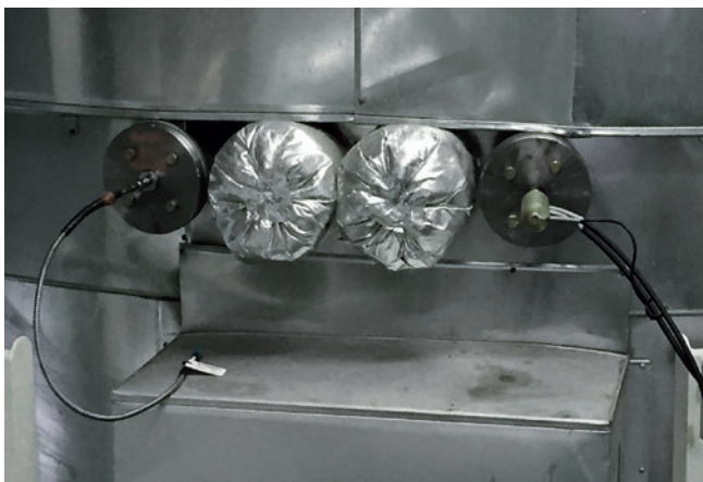
Sonda del testo 350, sujetado al lugar de medición con una brida.
