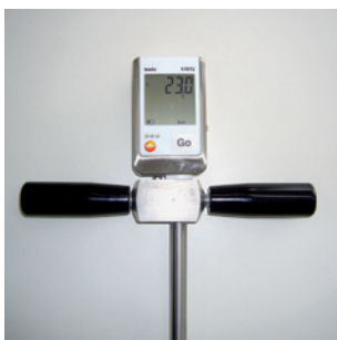
Einstecksonde mit Datenlogger testo 175-T2
