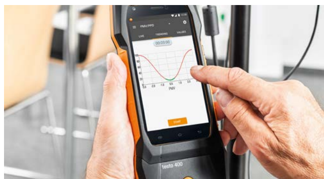
Рис. 4: Точный измерительный прибор testo 400 может определить или рассчитать большое число термодинамических параметров, включая температуру смоченного термометра.
