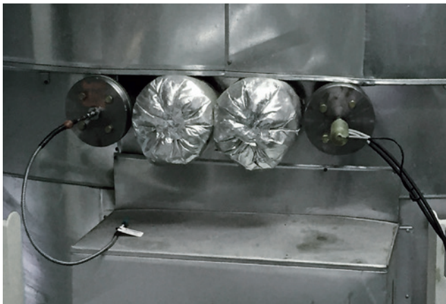
Sonde van de testo 350, via een flens bevestigd aan de meetplek.
