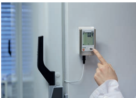
Aufzeichnung der °C- und %rF-Werte über Tage, Wochen und Monate auch in Archiven, Museen und Lagerhallen
