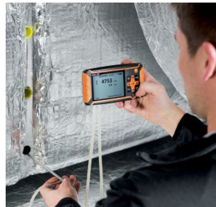
Misura con tubo di Pitot in un condotto
