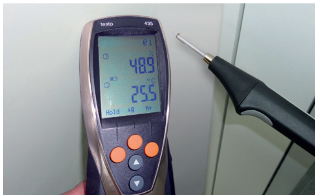
Feuchtemessung an empfindlicher Ware ohne Schranktüren zu öffnen.
