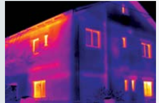
Deteção das perdas de energia em edifícios: Deteção e ilustração imediatas de pontes térmicas em fachadas ou no edifício.
