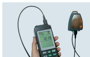
Überprüfung von Messwert-Umformern mit 4...20 mA-Interface
