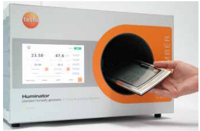
湿度发生器的显示单元和测量箱体
