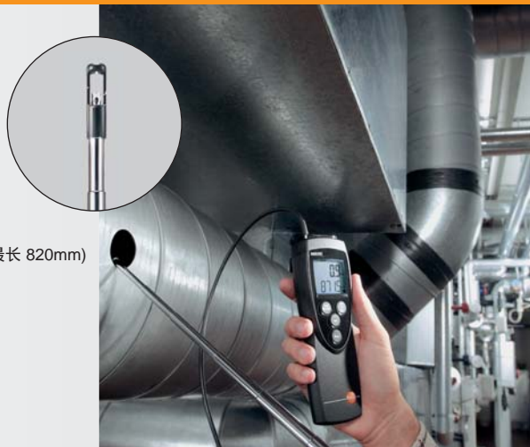
testo 425 监测通风管道的风速
