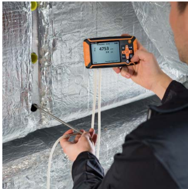
A kivethető mérőegység lehetővé teszi a Prandtl-csővel történő mérést légcsatornában. A Prandtl-cső külön rendelhető.
