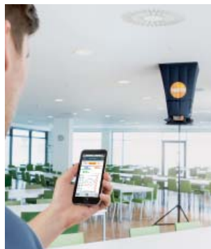
A mobilalkalmazás segítségével, a mérési adatok okoskészüléken is megjeleníthetők, valamint mérési jegyzőkönyv akár a helyszínen elkészíthető és továbbítható.
