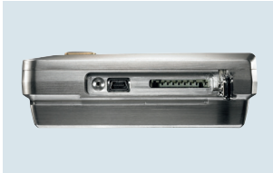
Mini USB kablo ve SD kart ile yan bağlantı
