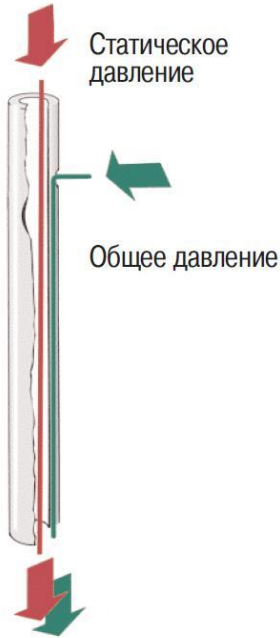
Рис. 1. Конструкция трубки модификации «Пито прямая»
