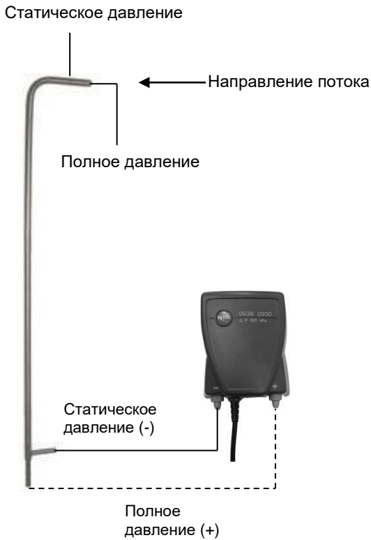
Рис. 4 Пример подсоединения к внешнему зонду давления Трубка модификации «Пито-Прандтля»
