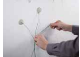
U-değeri probu sadece duvarın sıcaklığını değil, aynı zamanda iç ortam sıcaklığını da ölçer.
