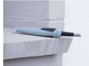
Dış ortam sıcaklığı testo 635'e* kablosuz bir prob ile aktarıldı.
