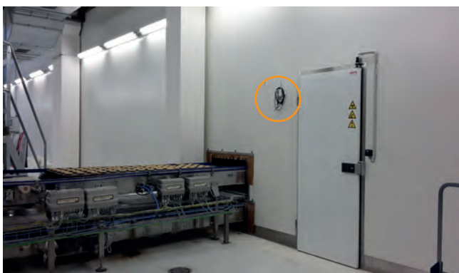
Teplotní sonda Saveris T1 umístěná v karuselovém chladicím zařízení.
