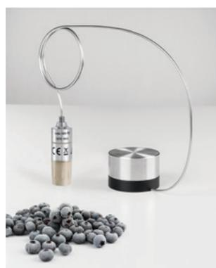
Misura della temperatura durante la liofilizzazione: testo 191-T3/-T4 + portasonda liofilizzazione
