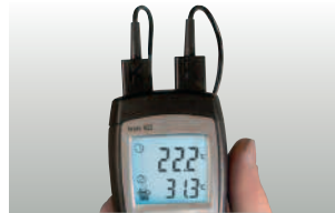
Bağlanmış iki proba eş zamanlı sıcaklık kaydı ve fark sıcaklığının görüntülenmesi
