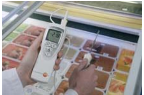
Pomiar temperatury powietrza w ladach chłodniczych i zamrażarkach
