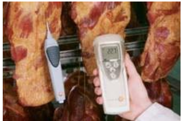
Penetracyjny pomiar temperatury przy wędzeniu żywności, bezprzewodowa transmisja radiowa danych pomiarowych
