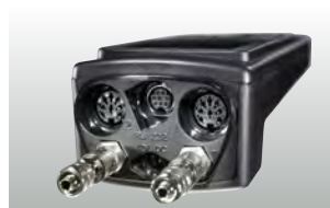
2 volně osaditelné vstupy pro tlakové a teplotní sondy
