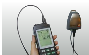
Kontrola převodníků s rozhraním 4...20 mA
