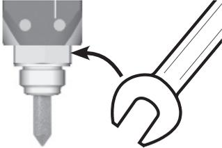
Wir empfehlen, das Gewinde des Prozessanschlusses mit einem Dichtungsband (z. B. PTFE) zu umwickeln oder einen Kupfer-Dichtring (Innendurchmesser 21mm) einzulegen.
