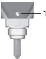
1 Prozessanschluss (G $\frac{1}{2}$  oder NPT $\frac{1}{2}$ ) in passendes Gewinde schrauben.
