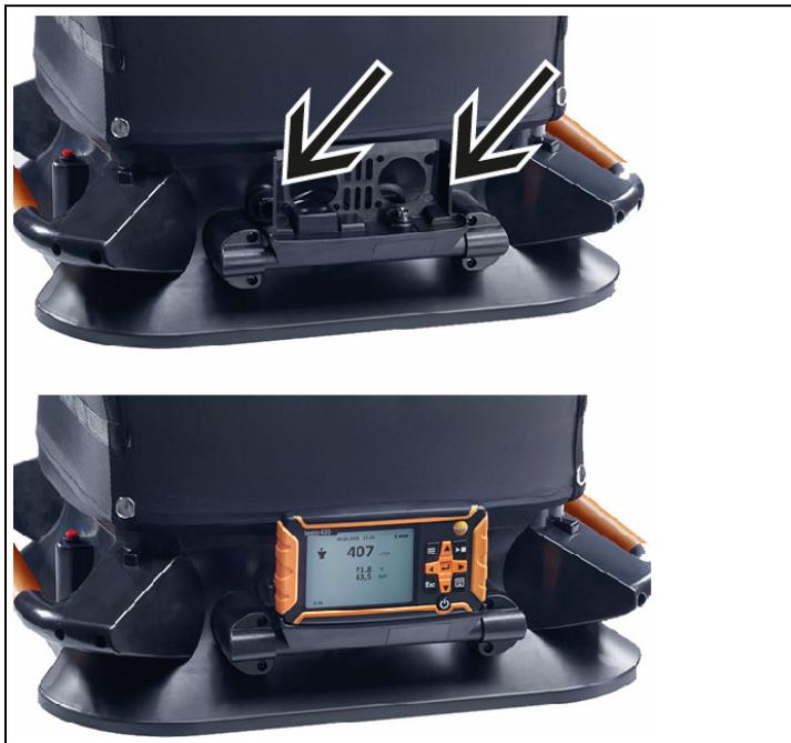
1. Coloque el testo 420 en el alojamiento correspondiente y, al hacerlo, preste atención al bloqueo a la derecha e izquierda en la sujeción.
