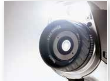
Wbudowany aparat cyfrowy z diodami LED
